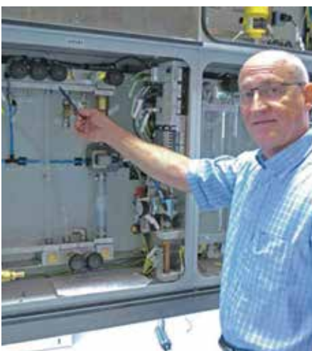
Udviklingschef Bjarne Lund, Agramkow Fluid Systems A/S, viser en af de ventilblokke, der har været med til at skabe orden i fyldestationens rørføringer.
